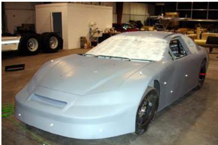
使用 Geomagic Design X 设计的 NASCAR 赛车外壳
